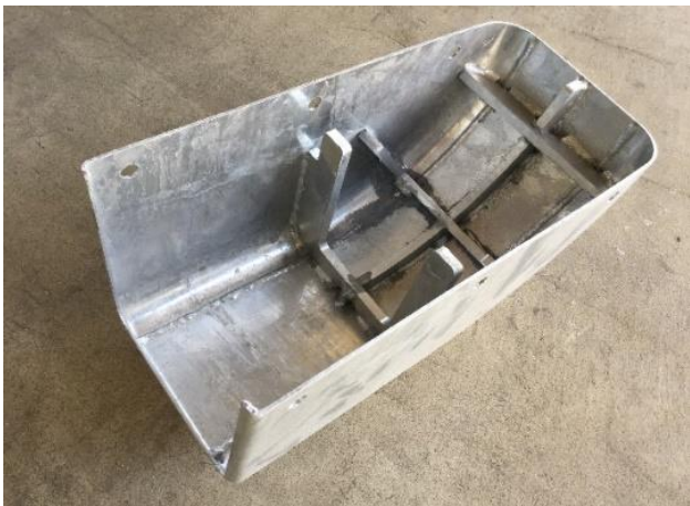
R部の隙間となる箇所を4枚のプレートにて補強。
