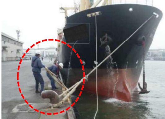
図 1.1 係船柱に船からの係留索を掛ける作業 1)
