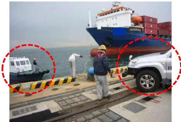
図 1.2 繫船ボートと車両の使用による係留索の引上げ作業
