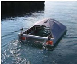
『エコボート』はリモコンで電動船外機を操作し、船体の開口部から海面のゴミを取り込むゴミ回収船です。
