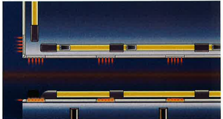
■光るコーナー材 配置例 夜間、船舶へ岸壁線を認識させます。
